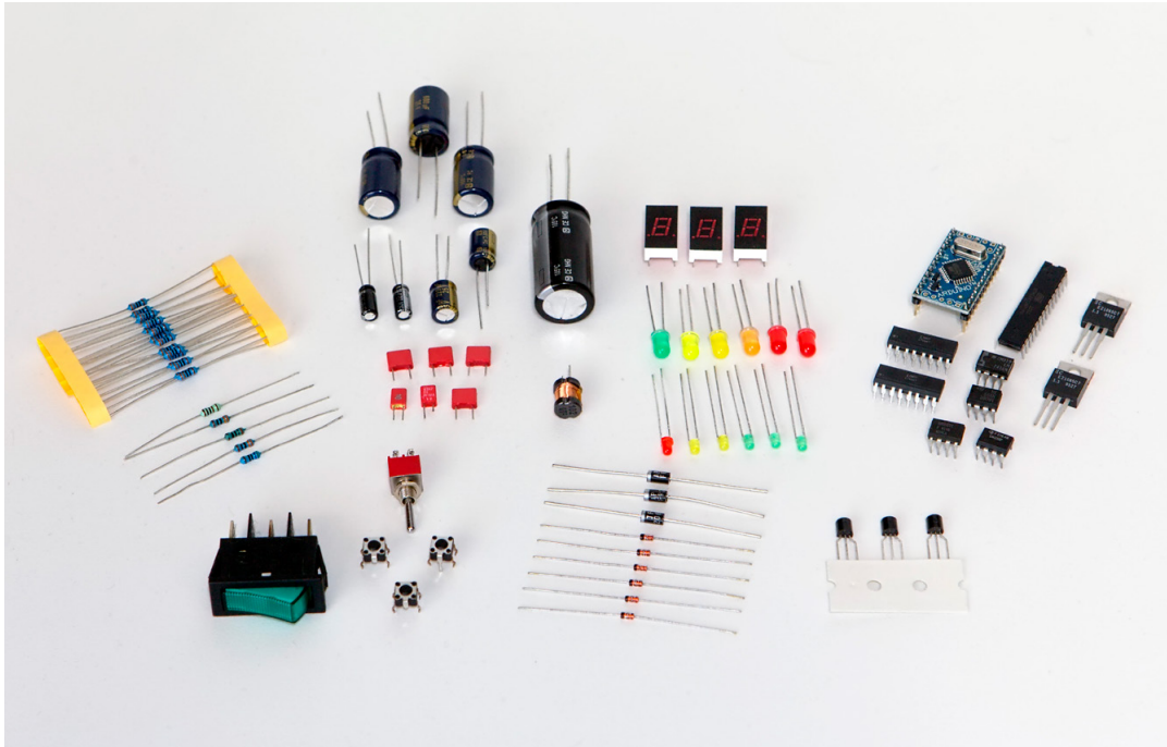
Valikoima erilaisia komponentteja. Karkeasti vasemmalta oikealle: vastuksia, kytkimiä ja painonappeja, kondensaattoreita, kela, diodeja, ledejä, erillistransistoreja ja mikropiirejä.
